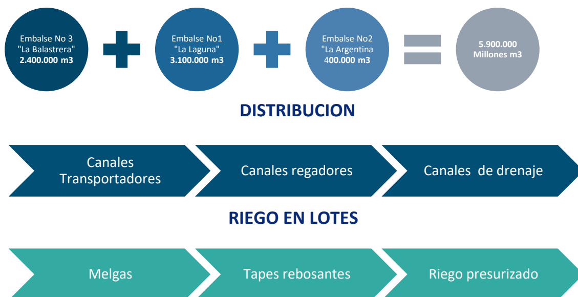
Ilustración 22 Sistema de riego
